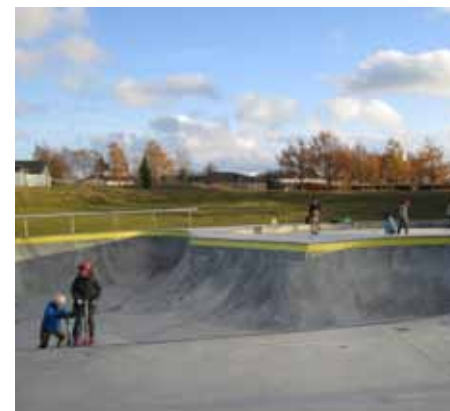
Eksempel på klimatilpasningsprojekt og skaterbane i ét. Det vil være oplagt, at der arbejdes med en løsning, hvor aktiviteter på de lavere beliggende arealer kan fungere som forsinkelsesbassiner ved skybrud. Rabalderparken, Roskilde.
